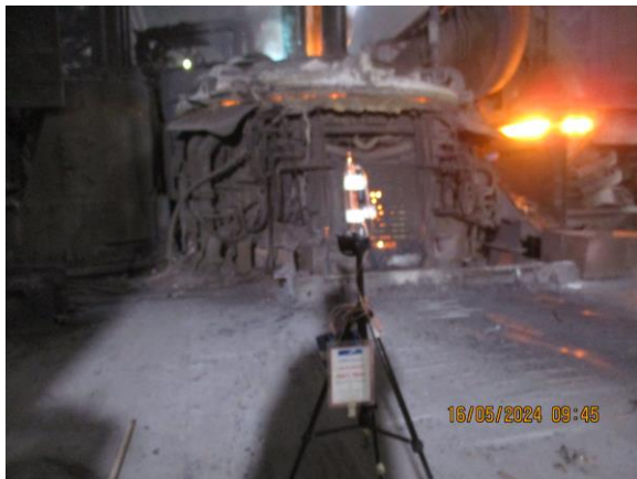
รูปที่ 4-66 ตรวจวัดคุณภาพอากาศบริเวณเตาหลอม EAF เก็บตัวอย่างในวันที่ 16 พฤษภาคม 2567
