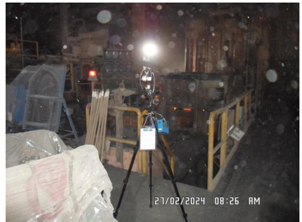
รูปที่ 4-65 ตรวจวัดคุณภาพอากาศบริเวณห่างจากเตาหลอม LF ประมาณ 10 เมตร เก็บตัวอย่างในวันที่ 27 กุมภาพันธ์ 2567
