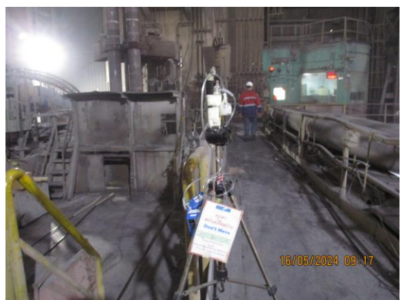
รูปที่ 4-69 ตรวจวัดคุณภาพอากาศบริเวณห่างจากเตาหลอม LF ประมาณ 10 เมตร เก็บตัวอย่างในวันที่ 16 พฤษภาคม 2567
