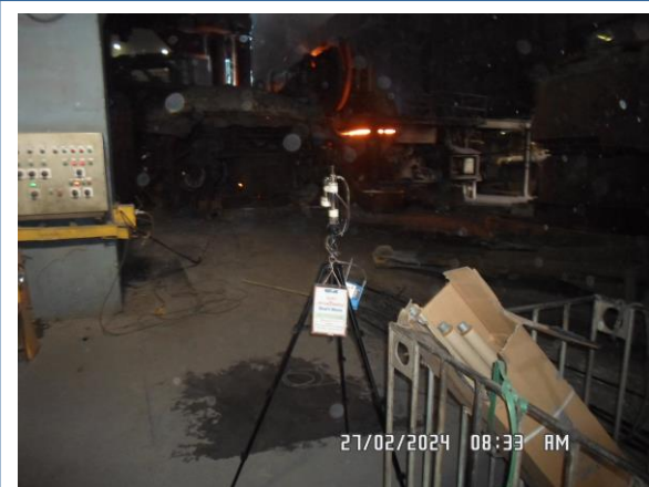
รูปที่ 4-62 ตรวจวัดคุณภาพอากาศบริเวณหน้าเตาหลอม EAF เก็บตัวอย่างในวันที่ 27 กุมภาพันธ์ 2567
