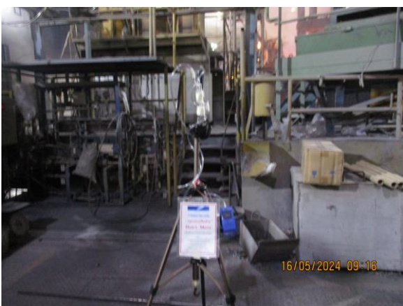
รูปที่ 4-68 ตรวจวัดคุณภาพอากาศบริเวณเตาหลอม LF เก็บตัวอย่างในวันที่ 16 พฤษภาคม 2567
